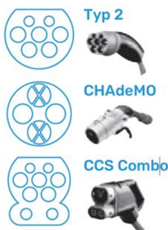
Rysunek 2.3. Najpopularniejsze rodzaje wtyczek przeznaczone do ładowania pojazdów elektrycznych w Europie
